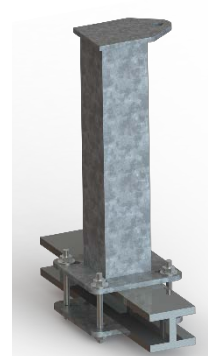
POSTE ABRAZADO A ESTRUCTURA METÁLICA
