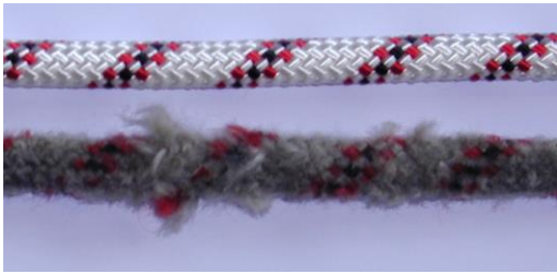
Ilustración 2: fuerte abrasión de la cuerda, desgaste con hinchazón de cuerda
