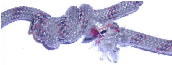
Ilustración 1.: Roturas de fibra en el nudo
