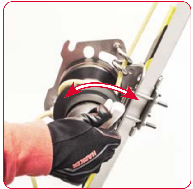
Controle la funcionalidad de la palanca de control de las semipoleas girándola y soltándola.
