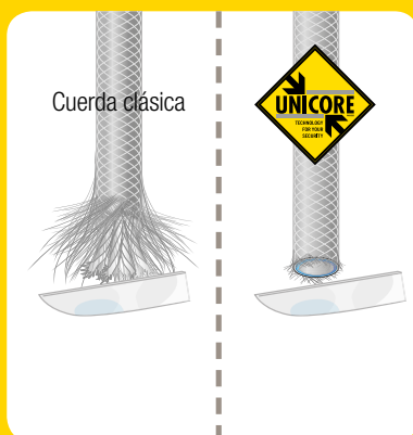
Permite cortar provisionalmente tramos de cuerda con un cuchillo, sin fundir las puntas, sin que la funda se deshilache.
